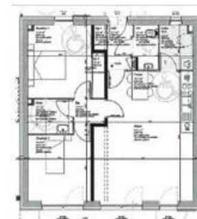
Plan d'un T3 en Rez-de-Chaussée aménagé pour les personnes à mobilité réduite (surface : environ 70m2)
